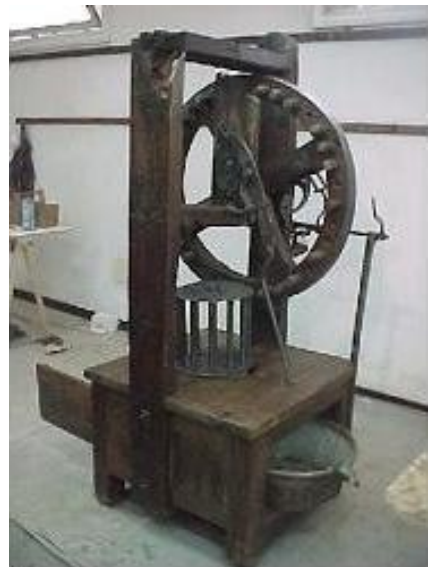
Macchina per l'estrazione dell'essenza di bergamotto. Museo Laografico, Bova Marina - RC
