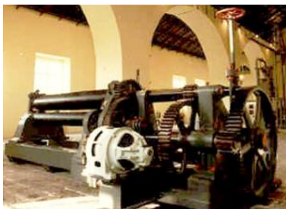
Pietrarsa: la calandra per la piegatura e l'arrotondamento delle lamiere
