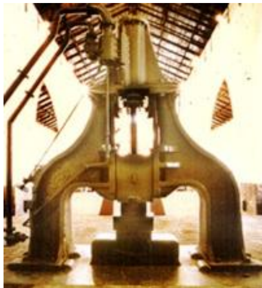
Pietrarsa: il maglio a vapore altezza 7 m; peso di battuta 2000 kg
